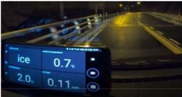
移動観測によるリアルタイム計測の実施
