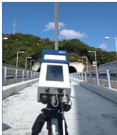
[ 振動計測によるケーブル張力測定 ]
